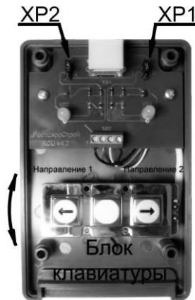
Вид пульта со снятой крышкой
